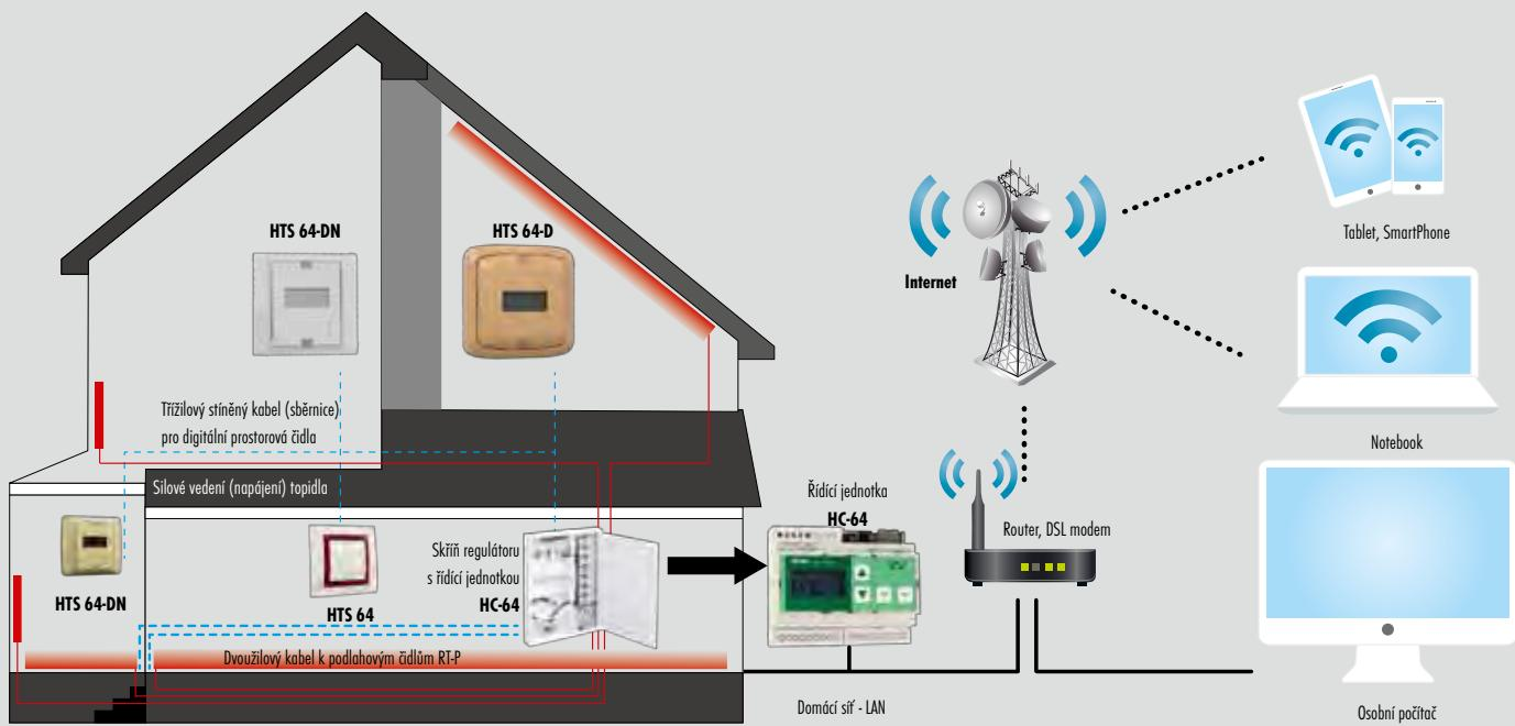
Silové vedení od každého topidla je až do regulátoru RT vedeno samostatně. Digitální čidla jsou připojena po sběrnici (trijízlový stíněný kabel), analogová čidla RT-L/RT-P jsou připojena k regulátoru dvoužilovým vodičem (každá samostatně).
